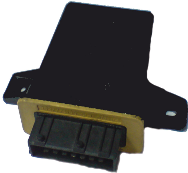
شکل 6-2 کنترل یونیت سیستم خنک کننده موتور
